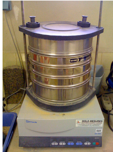
FIGURE 3 – Essai oedométrique et colonne de tamis sur table vibrante
