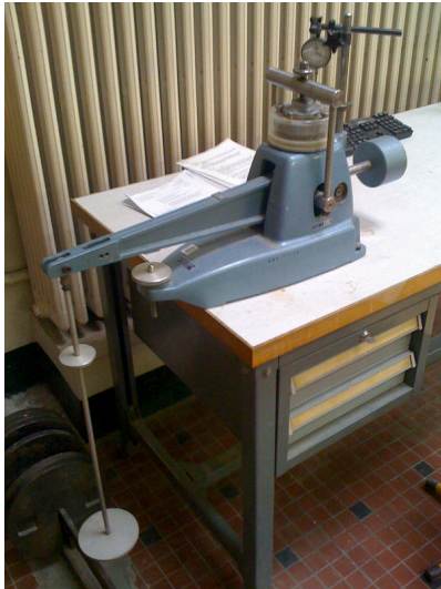
FIGURE 3 – Essai oedométrique et colonne de tamis sur table vibrante
